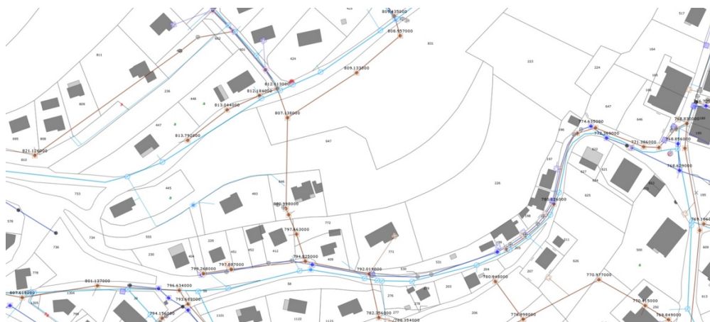
Figure 10 : réseaux d'assainissement et AEP secteur de la Combotte
