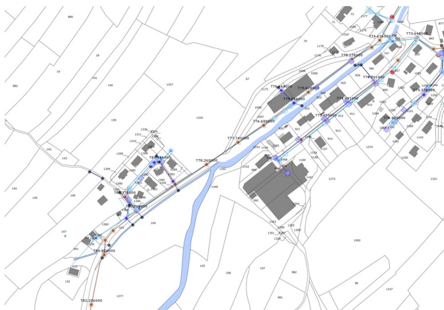
Figure 39 : réseaux d'assainissement et AEP
